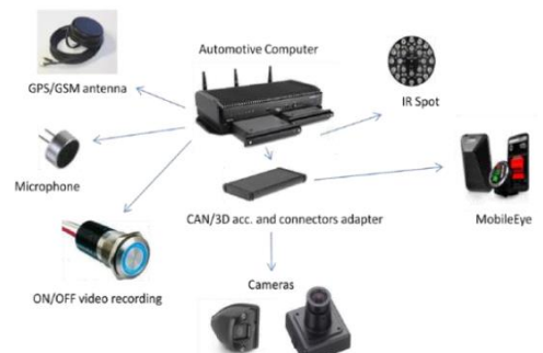
Figure 5 : l'EDR est constitué d'une multitude de capteurs
